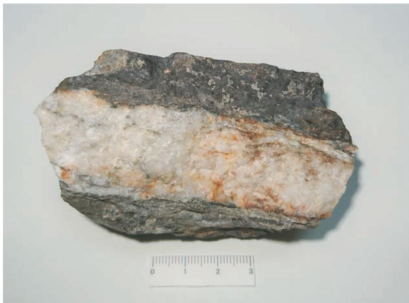
図3 岩盤の裂罅を充填した含金石英脈（女牛金山蓬来鉦床）
