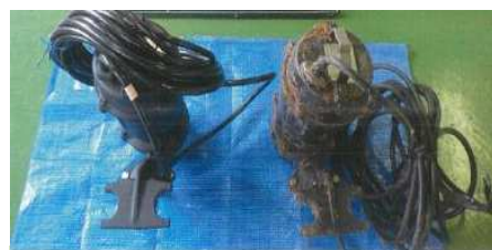
流量調整ポンプ
